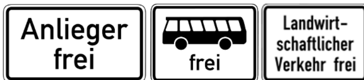
Abbildung 5: Beispiele von Zusatzzeichen der StVO zur Freigabe anderer Verkehrsteilnehmer auf einer RSV.
